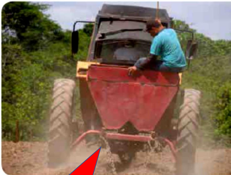
Semeadura em linha realizada com calcareadora adaptada. Detalhe para a saída das sementes da calcareadora sem o espalhador, com uma corrente para controlar a profundidade de semeadura.
